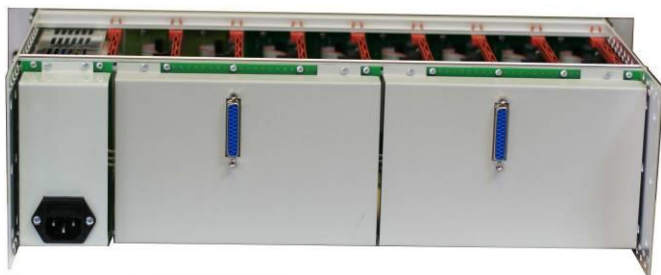
Рис.15. Вид на блок TR-E-103 с 8-ю модулями сзади.
