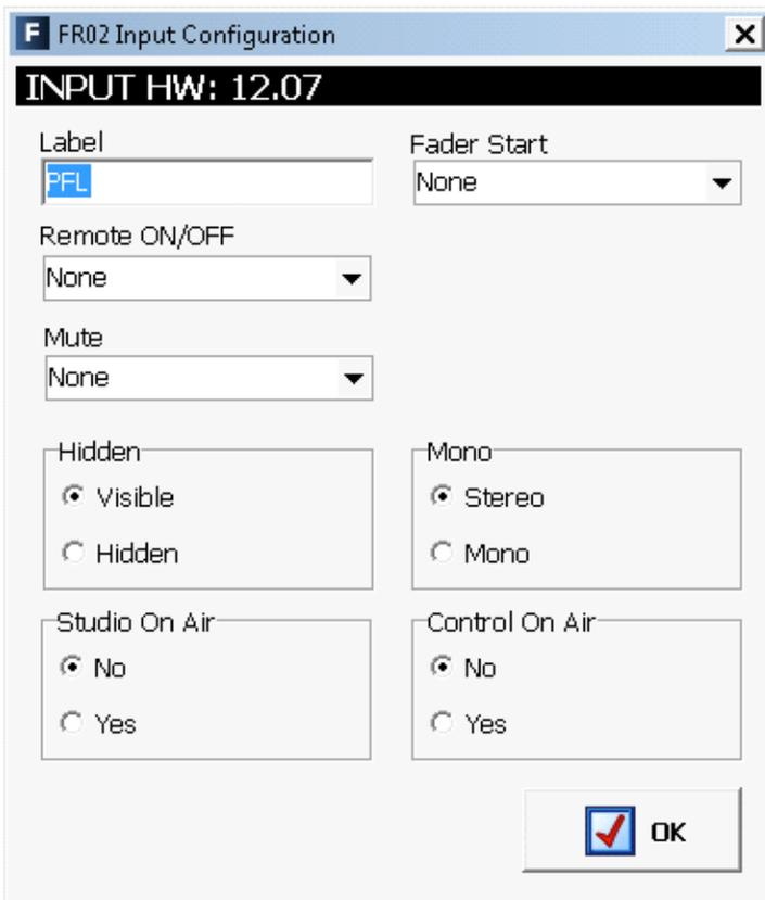
Далее созданный источник PFL нужно назначить на внутреннюю шину пульта, связанную с динамиком подслушки. Для этого необходимо перейти во вкладку Programmable Configuration -> Routing Configuration.
