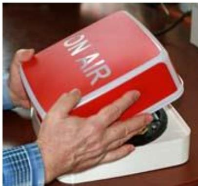
Рисунок 2 - Снятие плафона
