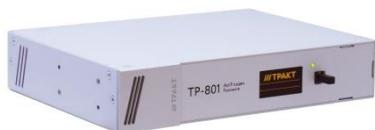
С помощью TP-801 можно подключить аналоговые источники звука, например, программный выход микшерного пульта, в комплекс служебной связи Синапс и использовать данные источники как постоянно вещающего абонента, в том числе для прослушивания программного звука с помощью терминала TP-812. Также TP-801 позволяет вывести любой звуковой поток назначаемый пользователем на
