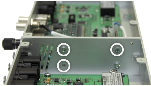
Рисунок 6.4 - Соединение двух блоков TP-702-1М.
