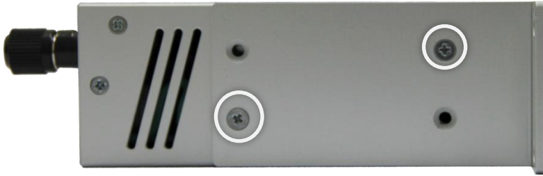
Рисунок 6.2 - Крепление уголка к блоку TP-702-1М
