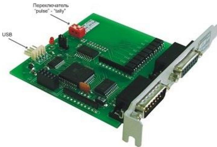
Рисунок 2.2 - Блок TP-318, плата для установки в ПК
