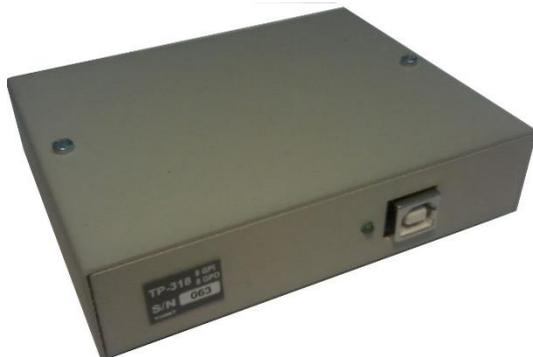
Рисунок 2.4 - Блок TP-318к, вид сзади
