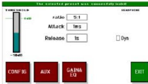
Выбрав параметр ratio (коэффициент), и повернув энкодер по часовой стрелке, мы активируем функцию ограничителя (limiter).
