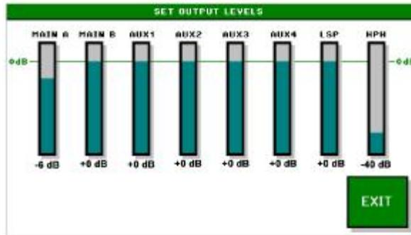
Для установки выходного уровня используется энкодер. Сначала необходимо выбрать нужный выход касанием соответствующего столбика. Далее установите необходимый уровень энкодером и подтвердите установку нажатием на энкодер. Таким образом можно регулировать уровни главных выходов без назначения на них мастер-фейдеров.
