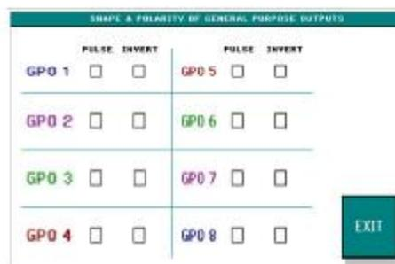
Здесь можно также установить тип (импульс) и полярность сигналов.
