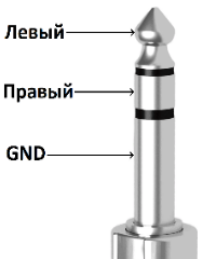
Рисунок 4 – Цоколёвка разъёма Jack 6.3mm 3pin
