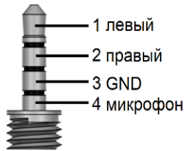
Рисунок 4.4 - Цоколёвка разъёма Mini-Jack 3.5mm 4pin
