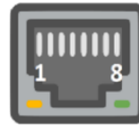
Рисунок 4.5 - Разъём RJ-45 для TP-804-Line
