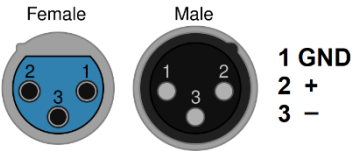
Рисунок 3.2 - Разъём XLR F и XLR M
