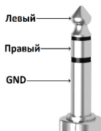
Рисунок 4 – Цоколёвка разъёма Jack 6.3mm 3pin
