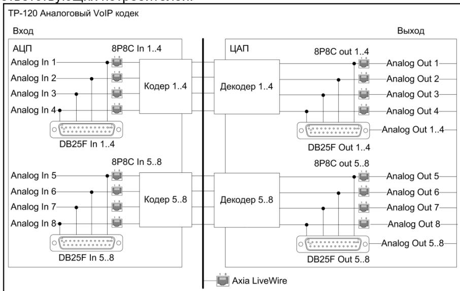
Рисунок 4.1- Схема функциональная
