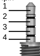
Рисунок 2.11 - Цоколёвка разъёма Mini-Jack 3.5mm 4pin
