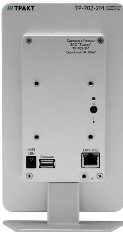
Рисунок 6.4 - Задняя панель блока TP-702-2M
