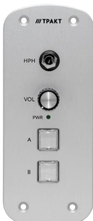
Рисунок 2.1 – Панель ТР-327, вид сверху
