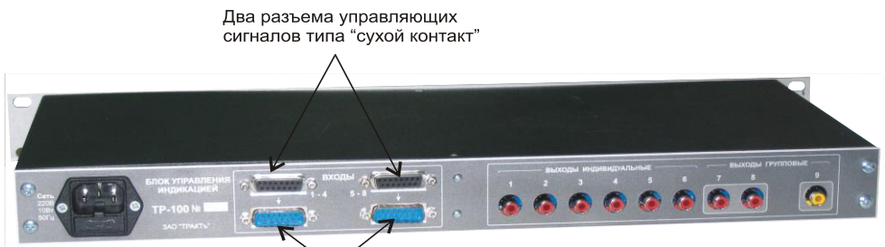
Рис.1. Задняя панель блока TP-100M, выпускаемого до 2010 года
