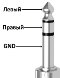
Рисунок 4 – Цоколёвка разъёма Jack 6.3mm 3pin
