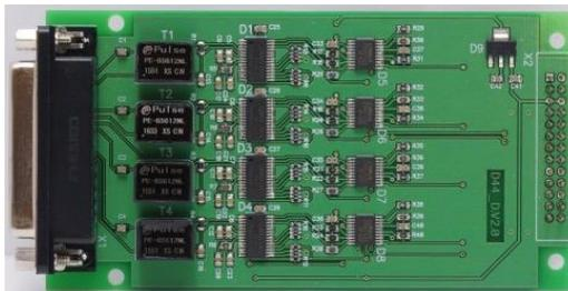
Рисунок 2.5 - Модуль TP-122-2, 4 AES входа
