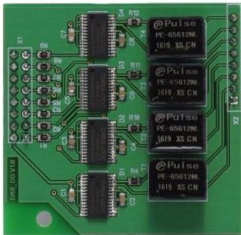
Рисунок 2.7 - Модуль TP-122-4, 4 AES выхода
