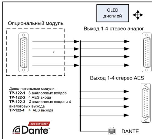
Рисунок 2.1 - Блок TP-122M, Схема структурная
