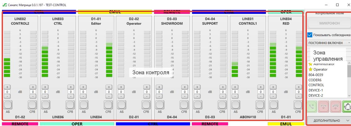
В отличие от учетной записи оператора, размеры окна контроля, запущенного из-под учетной записи администратора, невозможно изменить, приложение работает только в полноэкранном режиме. Администратор получает скрытую для контролера возможность изменить частоту тестового синусоидального сигнала в поле управления.
