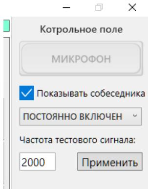
**ВАЖНО:** установленная в этом роле частота будет использоваться для всех расширенных контрольных полей. Частота в простом режиме контрольного поля по-прежнему остается 1кГц.
