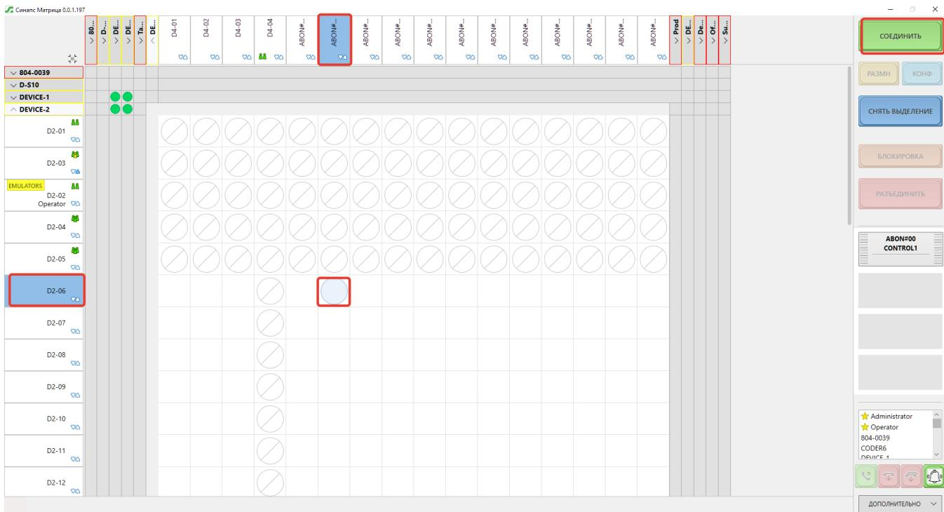
Ячейки пересечения абонентов, связь с которыми не может быть установлена, имеют однозначную маркировку (перечеркнутый круг).
