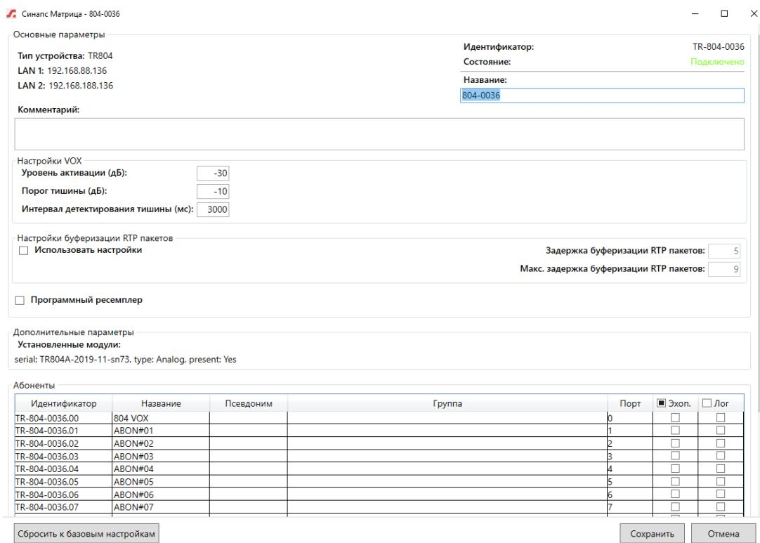
В этом окне можно просмотреть общие свойства преобразователя интерфейсов – Идентификатор, LAN1, LAN2, Состояние, список установленных модулей расширения (тип и серийные номера). Эти системные параметры нельзя изменить в данном окне.
