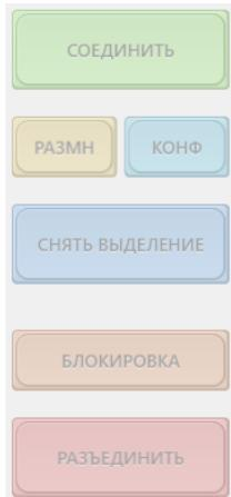
Кнопка «Соединить» позволяет соединить двух выбранных абонентов, при этом администратор может не выбирать отдельных абонентов, а просто кликнуть в точке пересечения – абоненты
