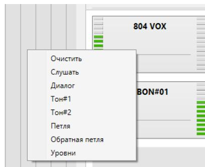
Действие «Очистить» позволяет снять назначение абонента на ячейку контроля. При наличии специальных режимов пользователю будет предложено либо оставить их включенными, либо сбросить в начальное состояние.
