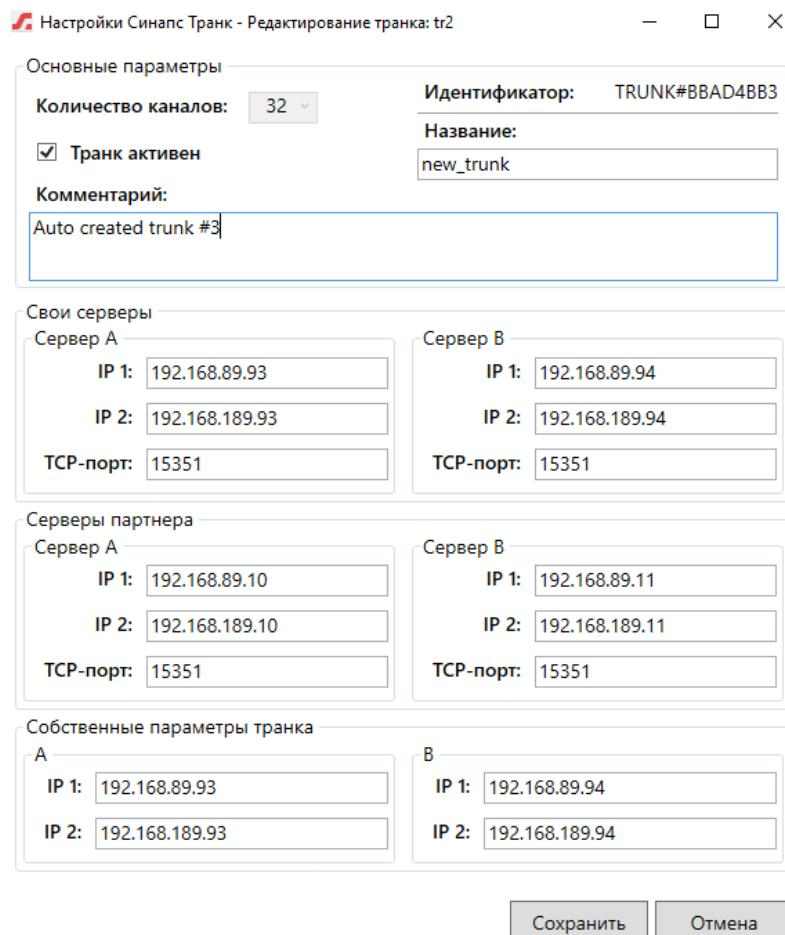
Следует помнить, что соединение Транк требует создания и лицензирования только с одной стороны, Транк-абоненты же лицензируются для каждого комплекса отдельно.
