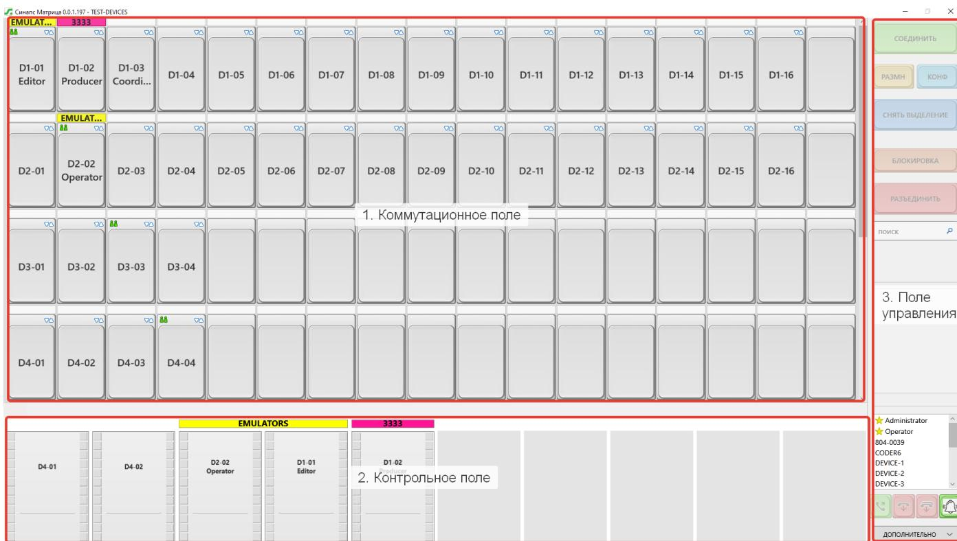
В любой момент времени оператор видит состояние назначенных в коммутационном поле абонентов; имеет возможность оперативного контроля абонентов, а также имеет возможность регулировать громкость каждого абонента.
