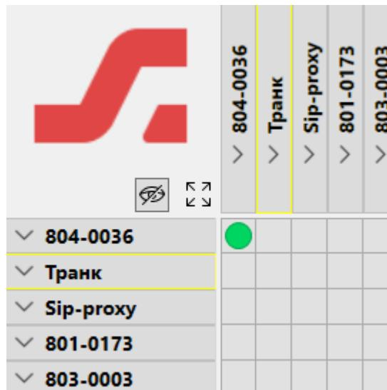
При нажатии на название устройства оно «раскрывается» и администратору видны все существующие в нём абоненты, а также установленные связи между отдельными абонентами.
