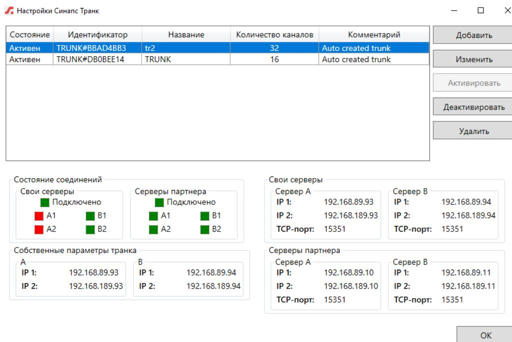
В основном окне администратор видит состояние каждого транк-соединения и может управлять им, а также добавлять новое. Лицензии Транк считаются в целом на комплекс, поэтому можно создать как одно подключение, например, на 32 абонента, так и 4 подключения по 8. Соединение Транк имеет от 8 до 32 абонентов с шагом 8, количество уникальных соединений Транк ограничено общим числом лицензий на подключение Транк-абонентов.
