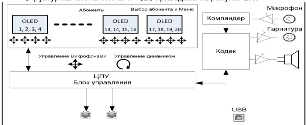
Рисунок 2.1 - Блок TP-820. Структурная схема
