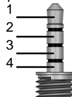
Рисунок 2.11 - Цоколёвка разъема Mini-Jack 3.5mm 4pin
