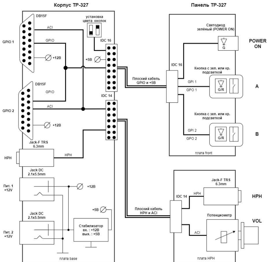
Рисунок 2.5 - TP-327. Схема структурная
