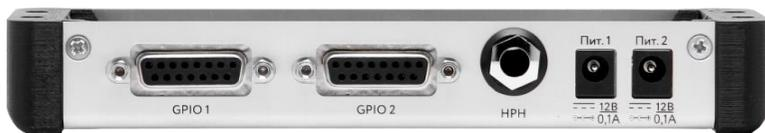
Рисунок 2.3 – Корпус TP-327, вид спереди.
