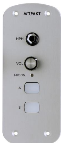
Рисунок 2.1 – Панель ТР-325, вид сверху
