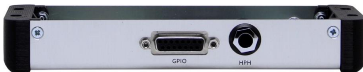
Рисунок 2.3 – Корпус TP-324, вид спереди.
