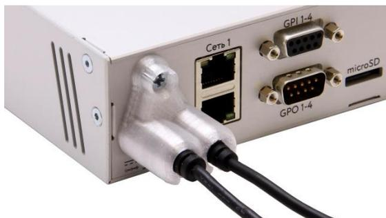
Рисунок 3.1 – Фиксатор кабеля БП
