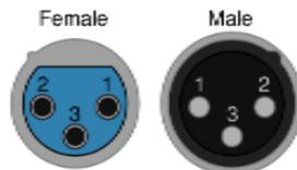
Рисунок 3.2 - Разъёмы XLR F и XLR M
