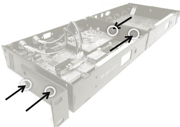
Рисунок 3.2 - Установка двух Блоков в стойку RACK 19"
