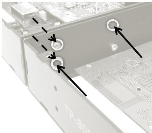
Рисунок 3.3 - Соединение двух Блоков
