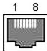
Рисунок 2.7 - Разъём RJ-45
