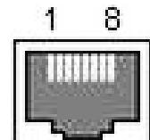
Рисунок 2.7 - Разъём RJ-45
