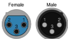
Рисунок 2.5 - Разъёмы XLR F и XLR M
