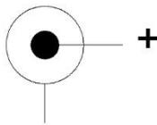
Рисунок 2.4 - Цоколёвка разъёма RCA
