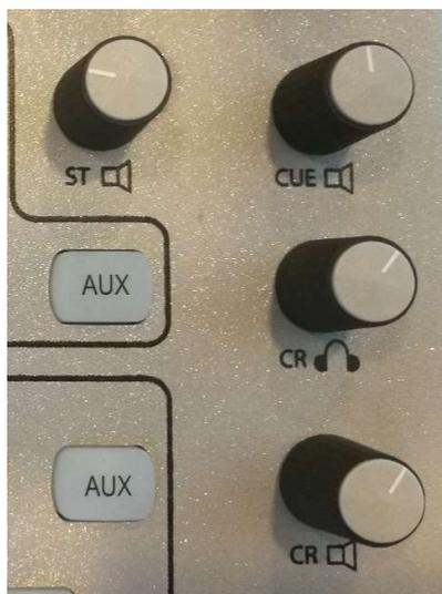
Оператор может регулировать громкость сигнала всех контрольных устройств с помощью поворотных энкодеров:
