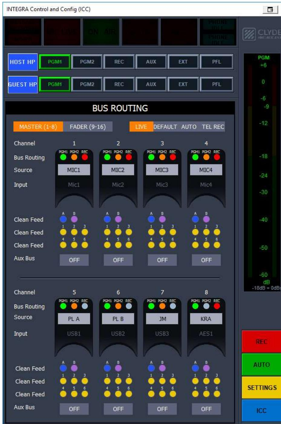
Для отображения окна свойств канала необходимо левой кнопкой мыши кликнуть по названию источника, например MIC1. Откроется окно **CHANNEL PROPERTIES**. Это окно можно вызвать непосредственно с пульта если нажать одновременно кнопки **SHIFT** и **TB/ASN** на выбранном канале.
