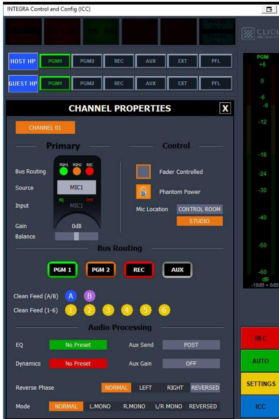
Желтая навигационная кнопка на пульте или кнопка **SETTINGS** на экране позволяет циклически перебирать настройки канала.
