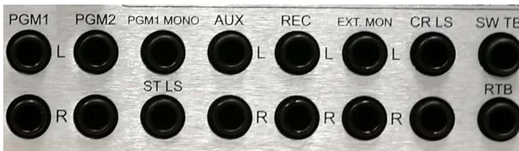
Все разъемы JACK ¼ на задней панели предназначены для балансных сигналов со следующей схемой подключения:
