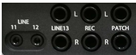
Некоторые входы и выходы для удобства вынесены на переднюю панель и оснащены разъемами типа Jack.
