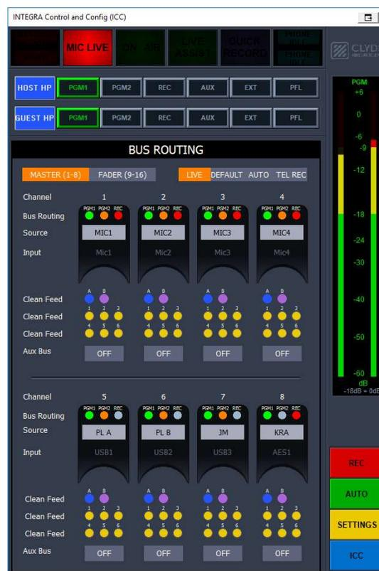
В правой части окна постоянно отображается измеритель уровня сигнала шины PGM1 и кнопки управления, которые связаны с физическими кнопками на консоли пульта.
