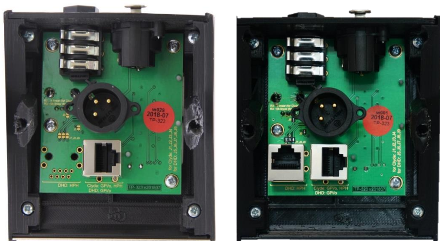
Рисунок 2.3 – Вид снизу, печатная плата. Панель TP-323-C – слева, Панель TP-323-D - справа.
